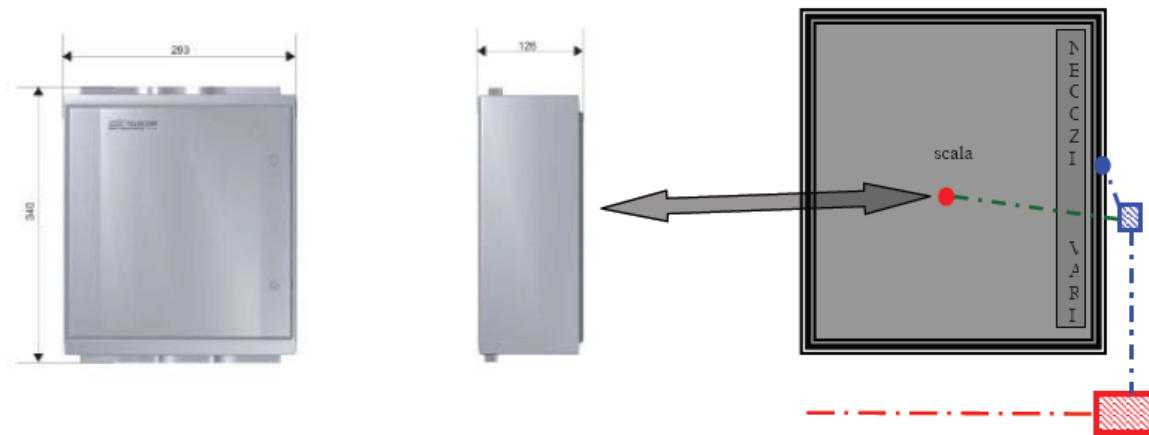
AREA TECNICA E TERMINALE INTERNO PER RETE IN RAME
