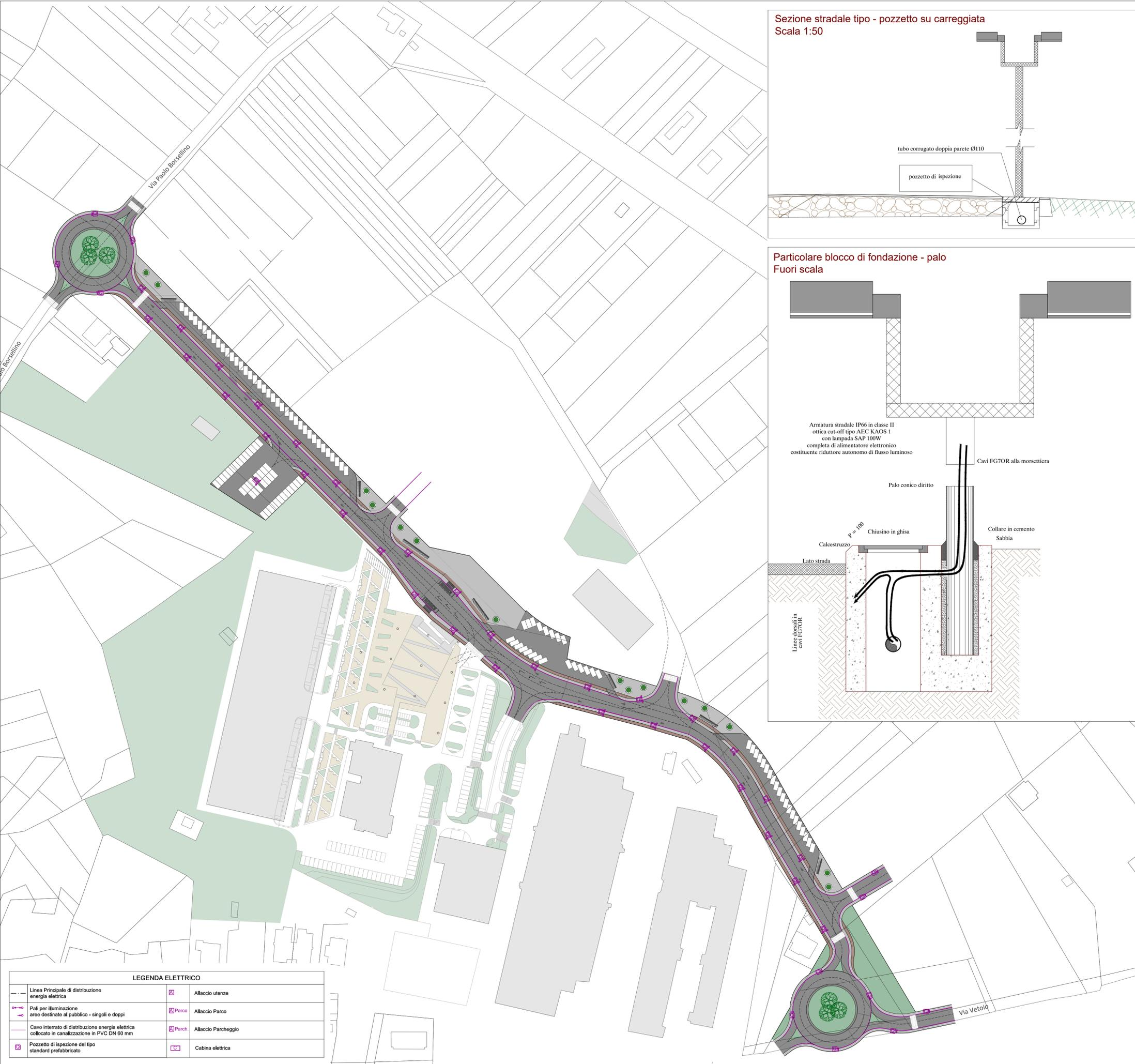
Sezione stradale tipo - pozzetto su carreggiata
