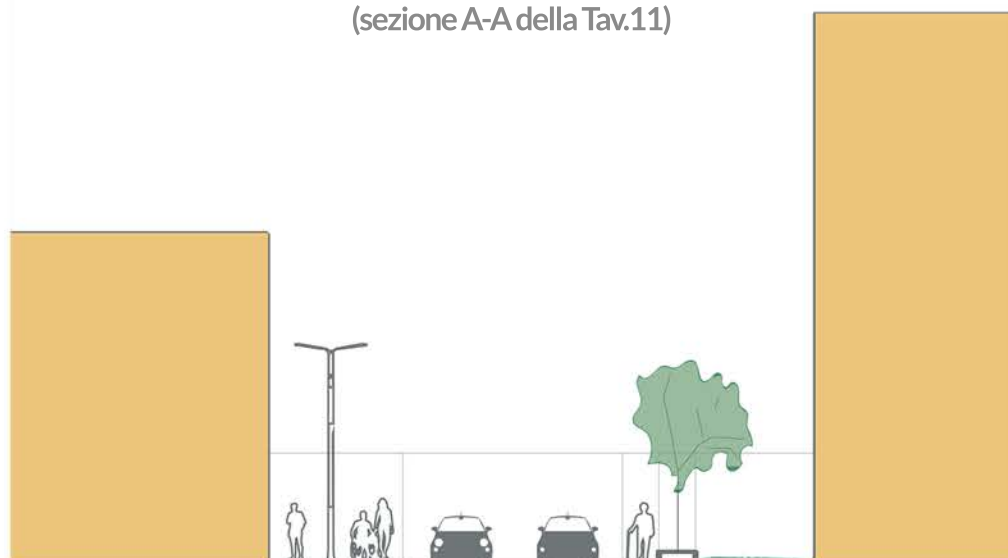
Sezione esemplificativa-Rimozione degli ostacoli dal marciapiede nella zona di ingresso al Blocco 1 (sezione A-A della Tav.11)
