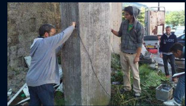
*Misura della velocità degli ultrasuoni*
