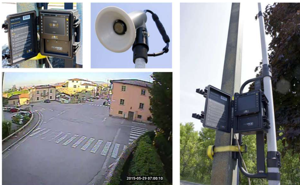
FIGURA 29 SISTEMA MIOVISION: TELECAMERA GRANDANGOLARE - VCU SCOUT – RIPRESA VIDEO
